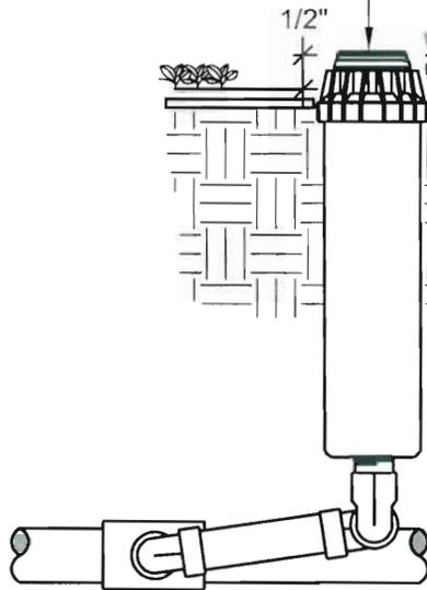
INSTALL SPRINKLER HEAD FLUSH WITH
